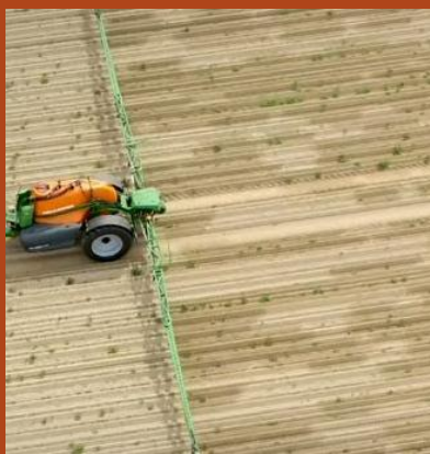
Figuur 2 Plaats specifiek spuiten (spot sprayen) d.m.v. een dronekaart.
