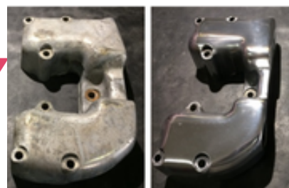
Fig.1 typische "onvolmaaktheden" in producten uit staal & kunststof d.m.v. nabewerken weg te werken (voor & na)
