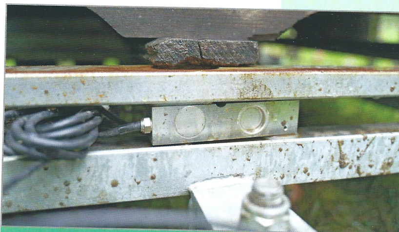
De weegcel zit aan de voorkant van een karretje tussen het basisframe en het weegframe. De weegcel krijgt de elektrische voeding vanaf de trekker. De kabel wordt van het ene naar andere karretje doorverbonden.
