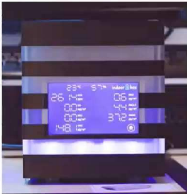
CO 2 -metingen in de klas: met sensorbox met display
