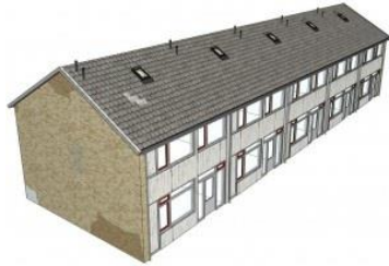
Figuur 1a – Referentie tussenwoning. De referentiewoning heeft een zuid gericht dakoppervlak van 30 \text{ m}^2 per woning met daarin verwerkt een dakraam van 1.4 \text{ m}^2 .
