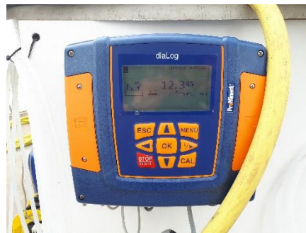
Figuur 2 a.) chemische weergave van waterstofperoxide, b.) meetpaneel om de waterstofperoxideconcentratie te monitoren (bron: Prominent Belgium S.A., N.V)
