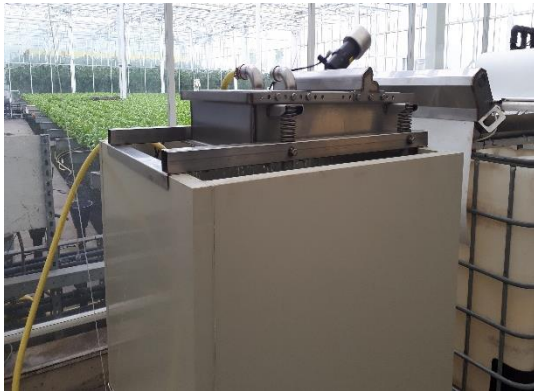
Figuur 20 Trilzeef in de tuinbouw. Vast afval wordt door het trillen afgevoerd naar het uiteinde van de zeef waarna het kan worden opgevangen in een bak.
