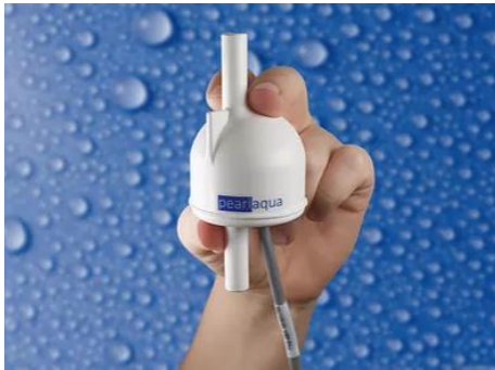
Figuur 6 UV-C LED is compacter en robuuster i.v.m UV -C licht uit kwartsbuizen, heeft bovendien een onmiddellijke werking en verliest niet in levensduur bij aan-uitschakelen. De energie-efficiëntie en potentiële te zuiveren waterdebieten zijn momenteel echter laag (bron: www.aquisense.com ).
