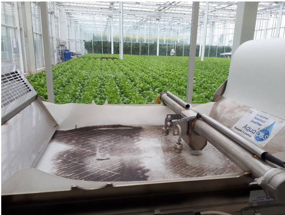
Figuur 13 Papierbandfilter als voorfiltratie in de tuinbouw.
