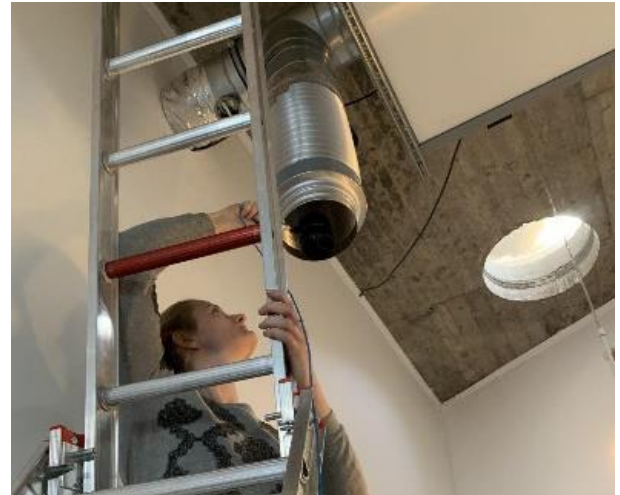
Afb.5. Meting met de Roatating Vane
