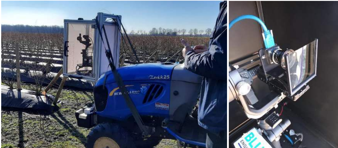
Figuur 9. (Links) Foto van de eerste operationele testopstelling in 2021 gemonteerd op tractor. (Rechts) Aanpassingen aan de opstelling in 2022 om de beeldkwaliteit te verbeteren (o.a. zwarte box en extra lichtfilter).
