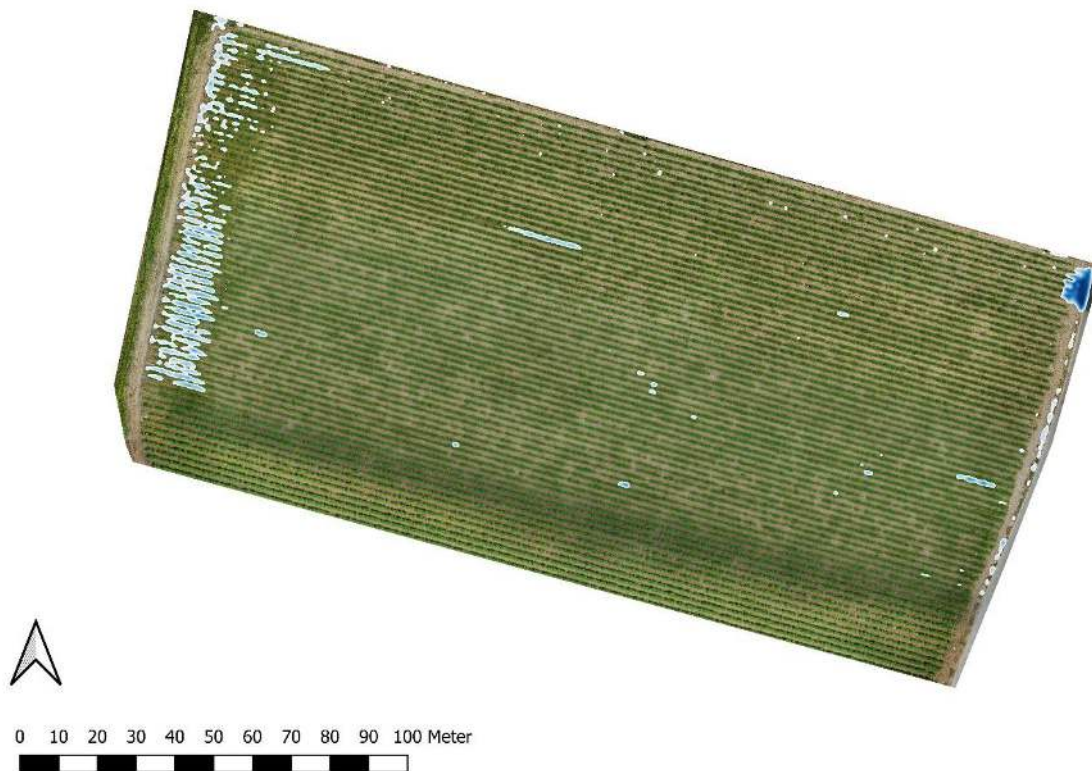
Figuur 4. Aanduiding van de lekkages in de druppelleiding op basis van het RGB-dronebeeld van 22 juli 2022 van het aspergeperceel te Kinrooi. In de hoek van het perceel wordt een zone foutief als lekkage aangeduid, dit is de schaduw van een boom die naast het perceel stond.
