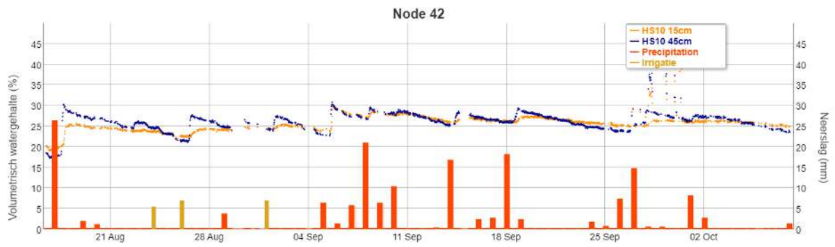
Figuur B. 21. Resultaten van de 10HS-sensoren voor node 42 op het prunusperceel te Venlo in 2022. De twee sensoren werden omgewisseld: blauw = 15 cm diepte, oranje = 45 cm diepte.
