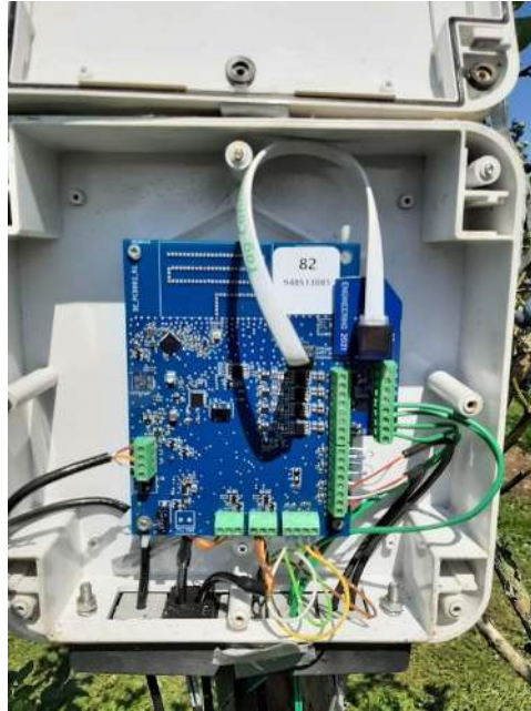
Figuur 4. Een sensornode met aangesloten sensoren.
