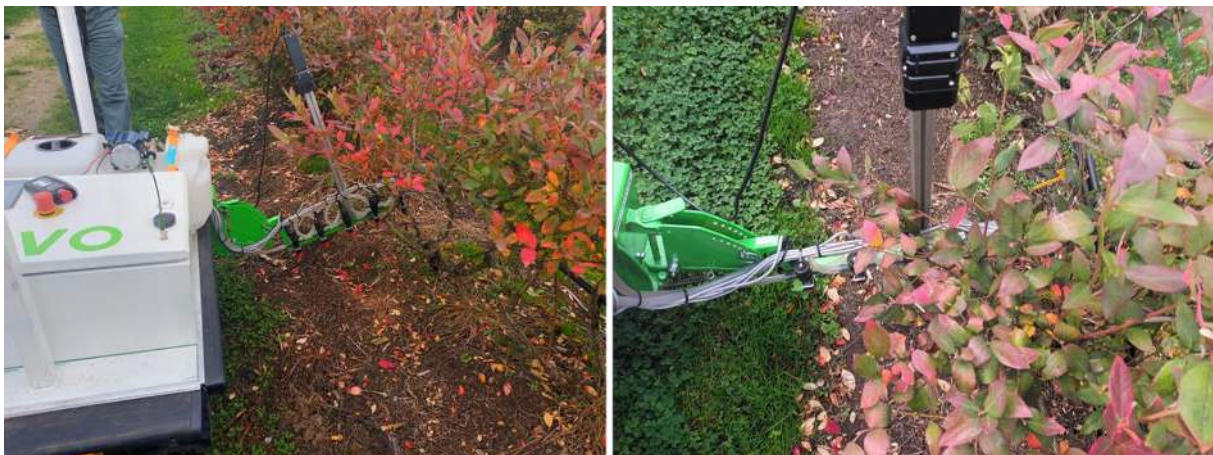
Figuur 7. Test met de Treebot op het blauwe bessenperceel te Oudsbergen (B) op 24/10/2022. De onderste takken van de struiken komen tussen de spuitboom en de camera waardoor de spuitdoppen onnodig aangeschakeld worden.
