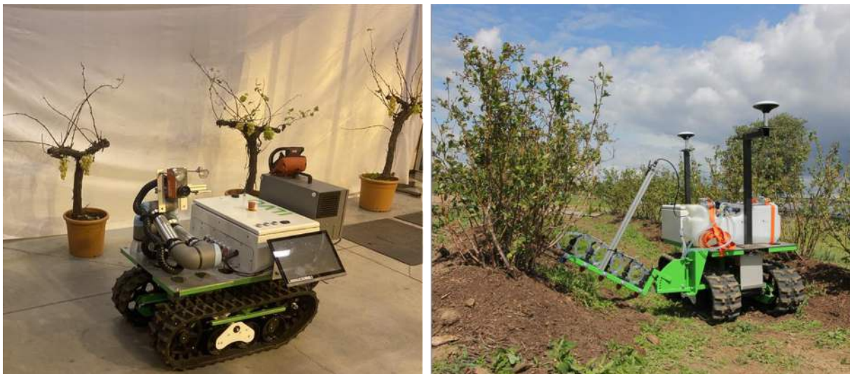
Figuur 6. Het Treebot platform voor (links) en na (rechts) de aanpassingen voor plaats specifieke bespuiting van onkruiden in de blauwe bessenteelt.
