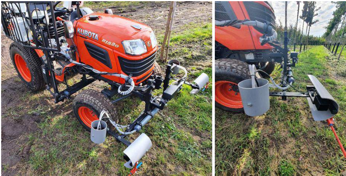
Figuur 4. Spot-On techniek van Mantis gemonteerd op een trekker voor toepassing van pelargonzuur in de laanbomen. Enkel wanneer de sensor een stam detecteert, wordt de spuitdop aangeschakeld.
