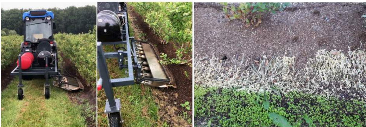
Figuur 9. Links: Eerste aangepaste versie van de WeedControl machine voor de blauwe bessenteelt. Rechts: Resultaat 3 dagen na toepassing van hete lucht met deze machine.
