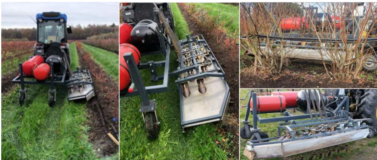
Figuur 10. Tweede aangepaste versie van de WeedControl machine voor de blauwe bessenteelt.
