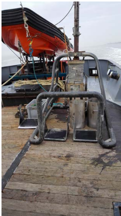
Figuur 5: De Reineck-Boxcorer, met het buizenframe incl gewichten, ketels en messen.
