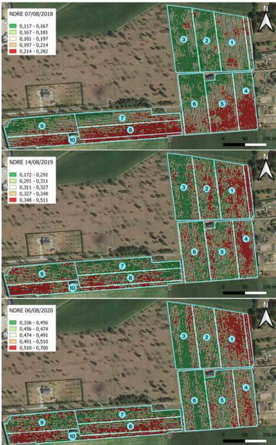
Figuur 1. – De NDRE-index berekend per boom uit dronebeelden voor het proefperceel te Rummen in augustus 2018, 2019 en 2020. De tien verschillende irrigatieblokken worden weergegeven met blauwe lijnen.
