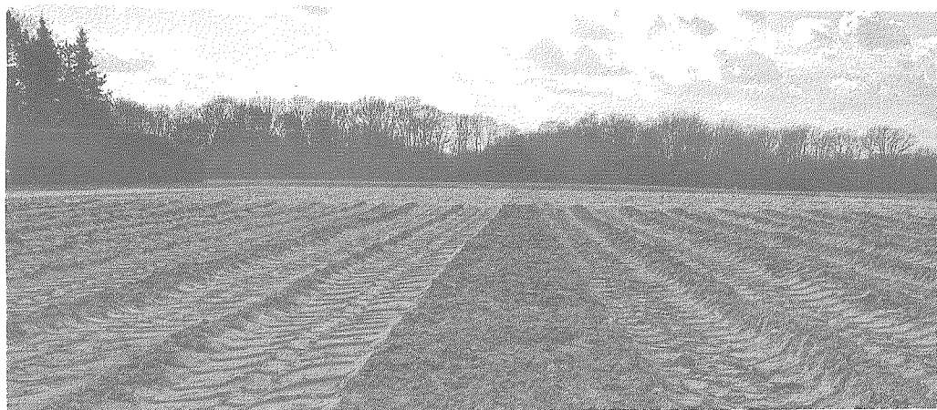
Het verschil in insporingsdiepte is duidelijk zichtbaar. Links: na passage van trekker + aanhangwagen op lage bandenspanning. Rechts: na trekker + aanhangwagen op hoge bandenspanning. Foto: KBIVB
