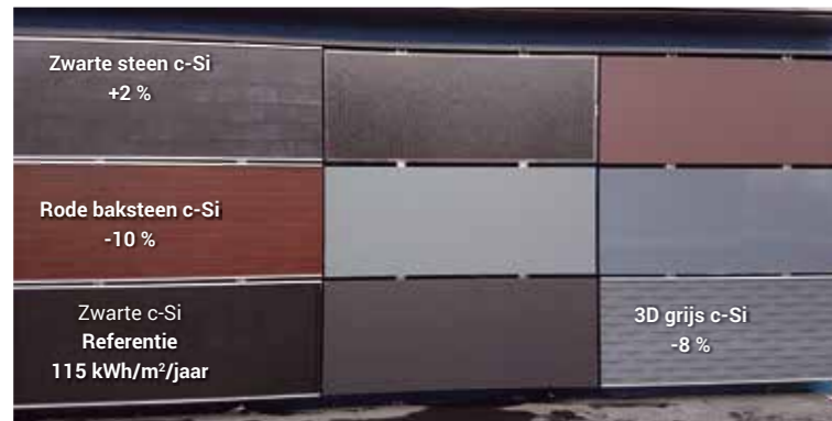
Figuur 10: DC Opbrengst van de tweede serie c-Si panelen, waarbij de panelen zijn voorzien van een motief en de "busbars" zwart zijn gekleurd.
