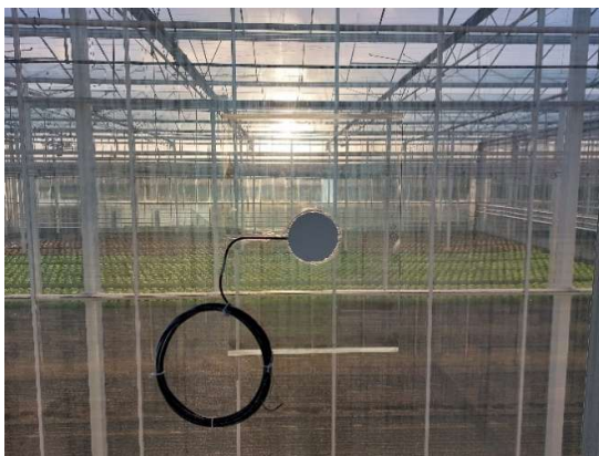
Fig. 6 Foto van de gebruikte warmtedoorgangssensors.
