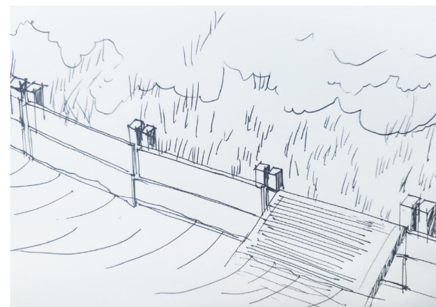
houten damwand met steinernlank
