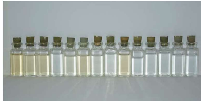
Afbeelding 38 Illustratieve foto van de geobserveerde verkleuring van drainwater afkomstig van verschillende LWS. De laatste in de reeks toont leidingwater als referentie.
