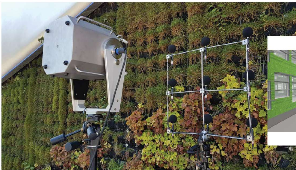
Afbeelding 26 Akoestische meting op een gevelgebonden groene wand.
