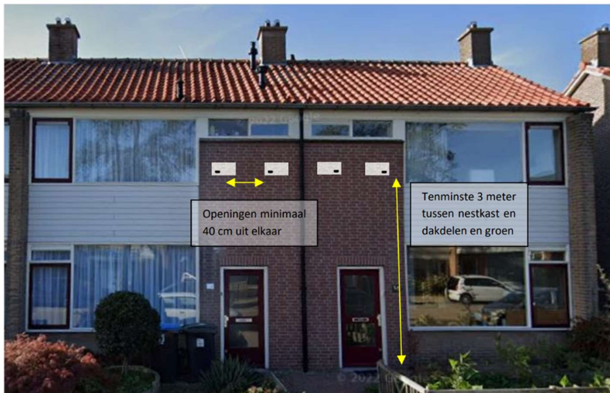
Figuur 3.13 Instructies plaatsen inbouwkasten GZP2 t.b.v. gierzwaluw in voorgevel.
