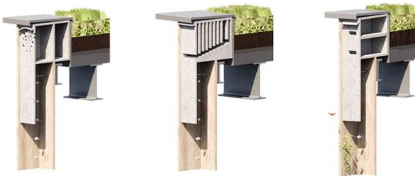
PRINCIPE INSECTENKASTEN, VLEERMUISKASTEN EN VOGELNESTEN
