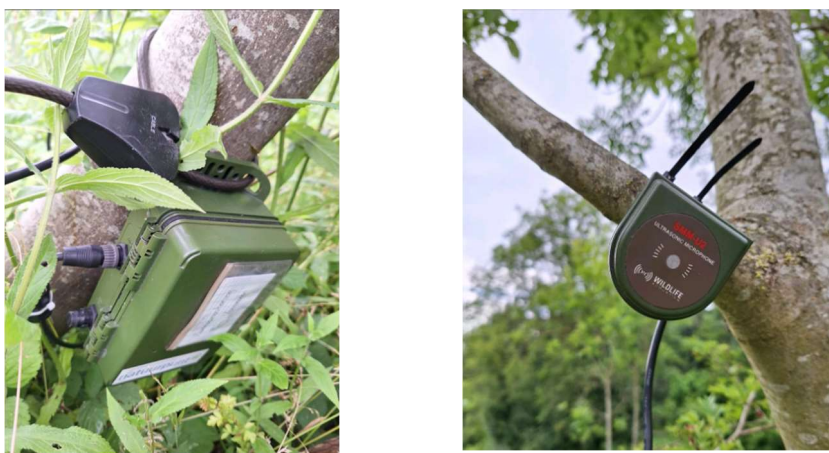
Afbeelding 5: bat detector Song Meter SM4BAT FS (foto links) met microfoon (foto rechts) bevestigd aan een boom (foto's Niels Luyten).
