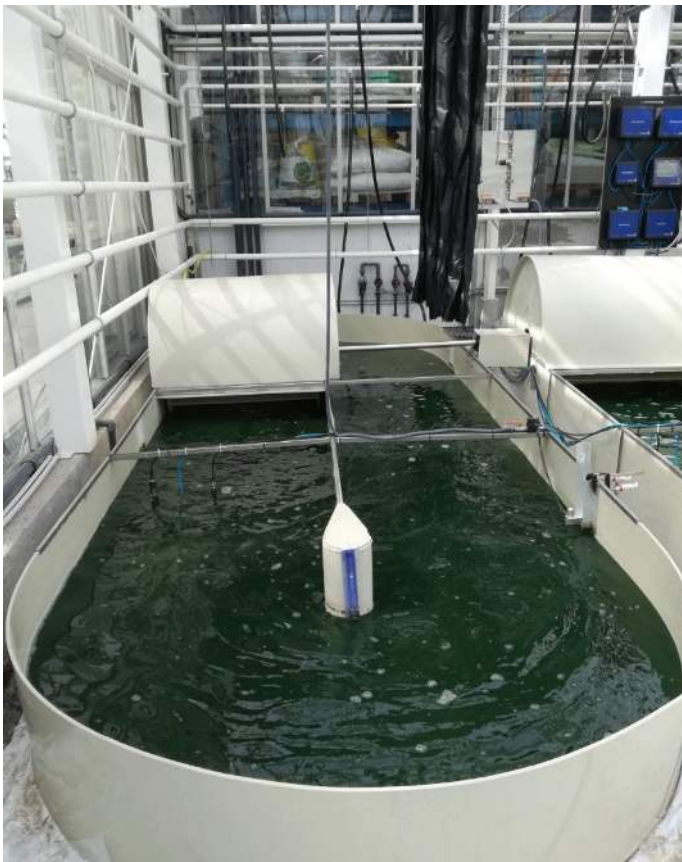
Figuur 2: productie van Spirulina in een raceway pond
