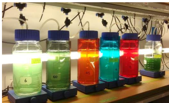
Figuur 4: Spirulina blootgesteld aan verschillende kleuren licht door middel van een lichtfilter
