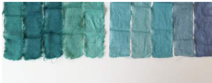
Figuur 7: Wol geverfd met PCB en verschillende stabilisatoren
