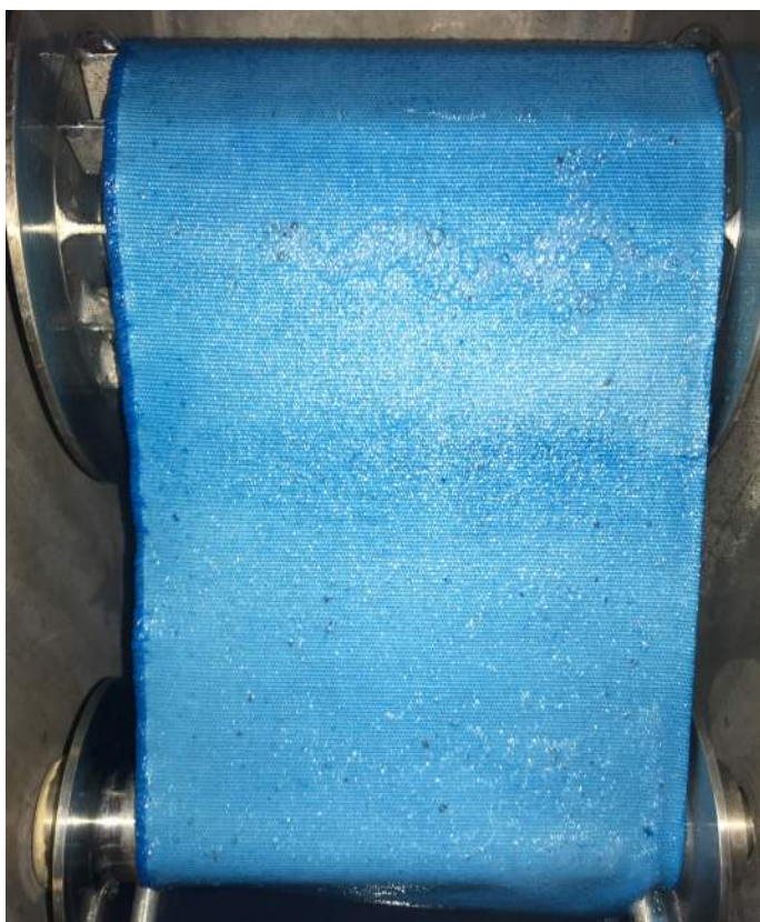
Figuur 1: Tijdens een warm verfproces wordt een textiel cyclisch ondergedompeld in het verfbad
