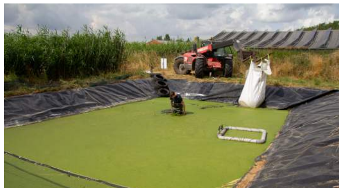
Figuur 4: "Duckweed Skimmer" in werking: de pomp zuigt de bovenste waterlaag naar zich toe waardoor voornamelijk eendenkroos wordt geoogst.
