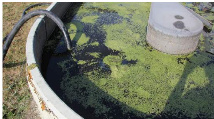
Figuur 3: "Duckweed Skimmer" in werking: de pomp zuigt de bovenste waterlaag naar zich toe waardoor voornamelijk eendenkroos wordt geoogst.
